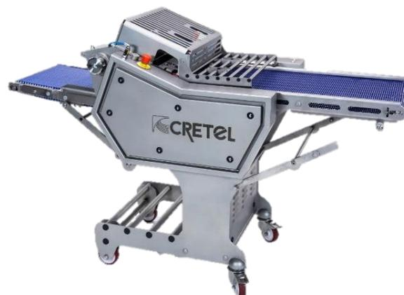
**Máquina de remoção de pele de peixe totalmente automática com transportador de entrada e saída. Os transportadores de entrada e saída tornam a máquina adequada para uso em uma linha de produção industrial. Esta máquina de remoção de pele de peixe multiuso está disponível com uma gama de rolos dentados para se adequar à sua aplicação.**
