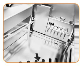
A garra automática garante uma fixação segura do produto a cortar e permanece uma garra particularmente pequena.
