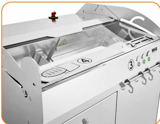
**A lâmina não pode ser operada se a máquina não estiver 100% bloqueada.**
