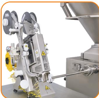
Pode operar conectado a uma máquina de vácuo ou a um enchedor a pistão
